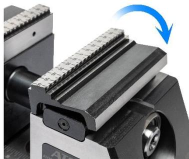
Ein technisch optimiertes Backen-Schnellwechselsystem ermöglicht Anwendern sekundenschnelle Tauschvorgänge. Das reduziert Rüstzeiten und beschleunigt die Produktion.
